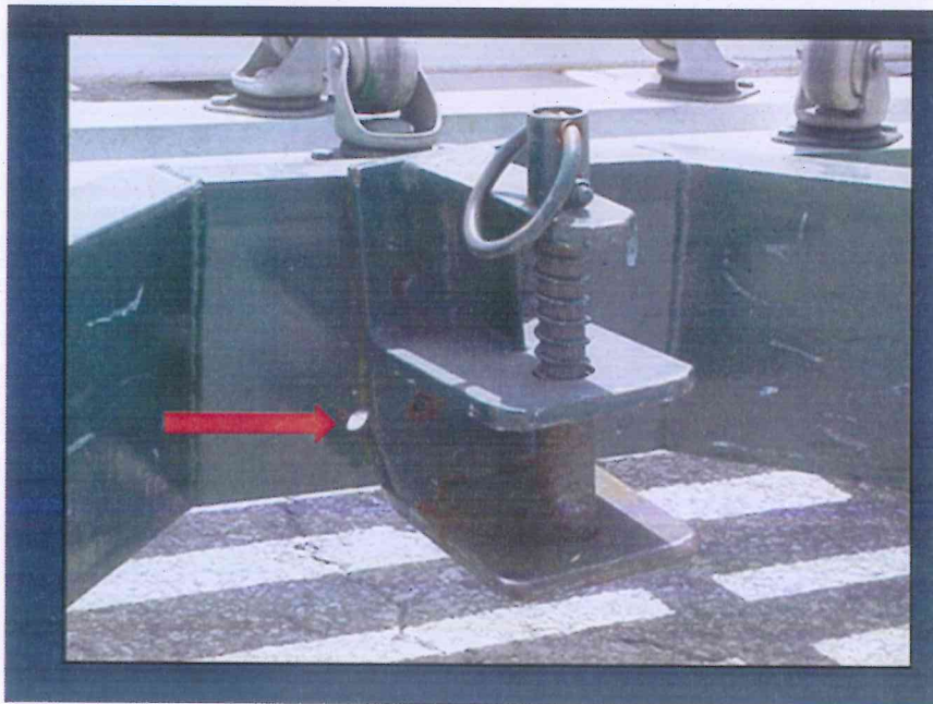
Enganche en mal estado.
