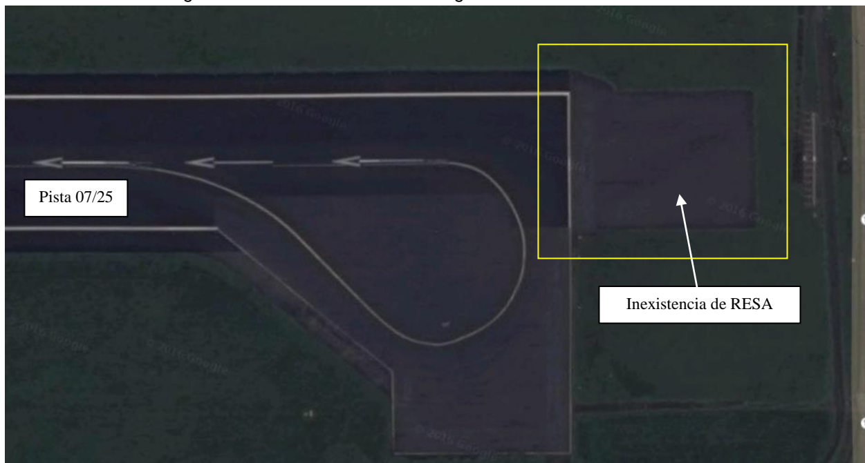
Imagen 1 Inexistencia de Área de Seguridad de Extremo de la Pista 07
