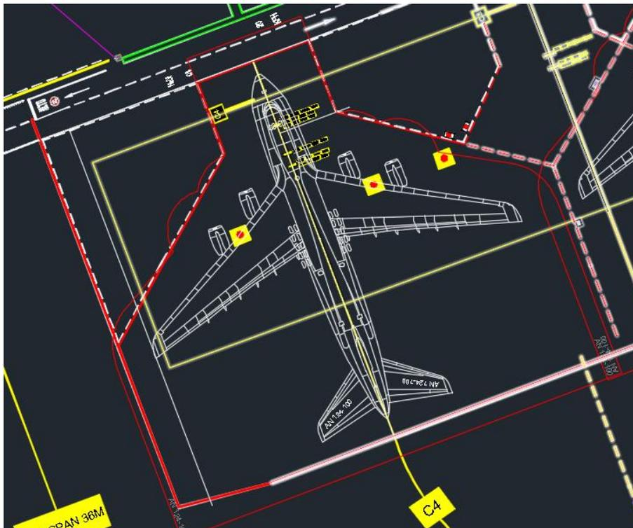
La aeronave no presenta el riesgo de colisión con ningún objeto fijo, sin embargo, no se cumple con el criterio de separación de 7.5 metros (RAC 14) con la zona de seguridad de equipos y la calle vehicular, por lo que como medida de mitigación la aeronave debe ingresar remolcada con señaleros a la posición de estacionamiento, esto siguiendo el **Procedimiento Operativo de la rampa remota**.
