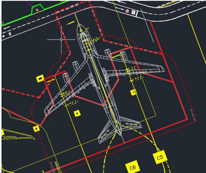
La aeronave no presenta el riesgo de colisión con ningún objeto fijo, sin embargo, no se cumple con el criterio de separación de 7.5 metros (RAC 14) con la zona de seguridad de equipos, por lo que como medida de mitigación la aeronave debe ingresar remolcada con señaleros a la posición de estacionamiento, esto siguiendo el **Procedimiento Operativo de la rampa remota**.
