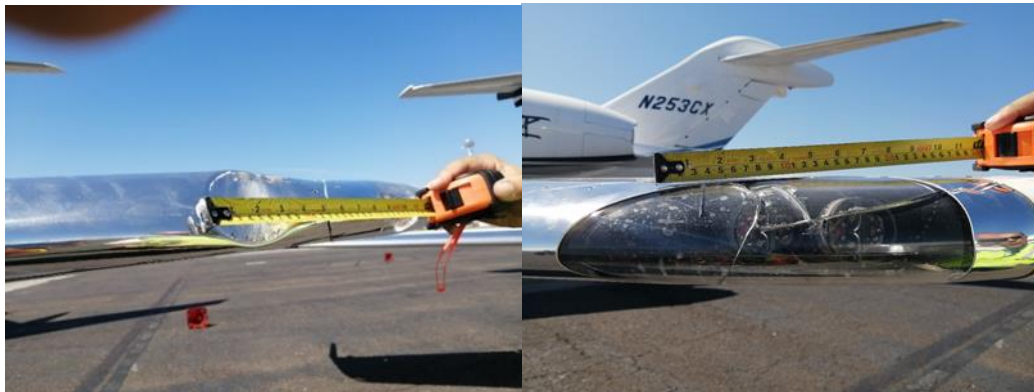
Imágenes 2 y 3. Daños presentes en la punta de ala izquierda N253CX.
