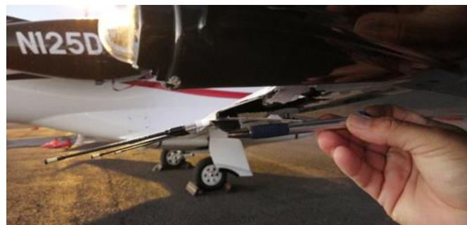
Imagen 13. Alojamiento de luz estroboscópica del N125DT.
