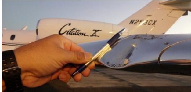
Imagen 11. Abolladura borde de ataque del N253CX.
