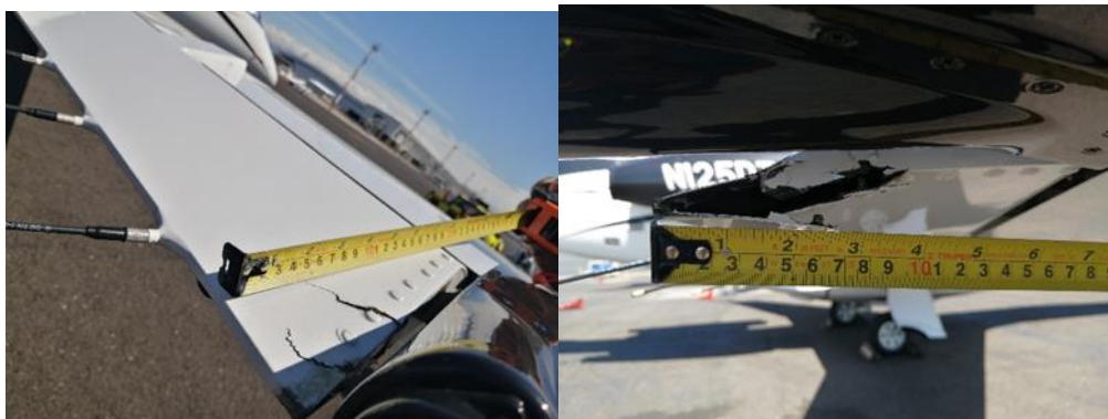
Imágenes 4 y 5. Daños presentan en el wingtip derecho del N125DT.
