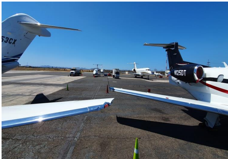
Imagen 15. Vista de frente de las punteras de alas que colisionaron.
