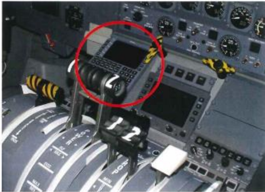
Figura 6: Cabina de vuelo con tripulación múltiple con una instalación GNSS única
