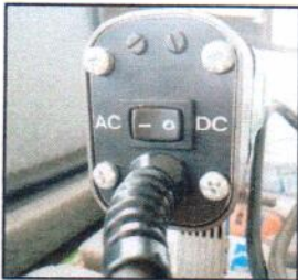
Foto 4. Control AC / DC.
