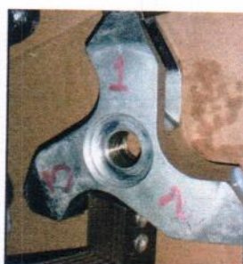
Imagen 2. Magnetización longitudinal, punta N°1.
