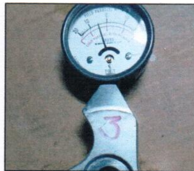
Imagen 12. Magnetismo remanente después de inspección, punta N°3.
