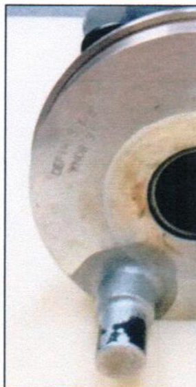
Imagen 3. PROPELLER BLADE N° 3, Radius Bushing, Pitch Change
