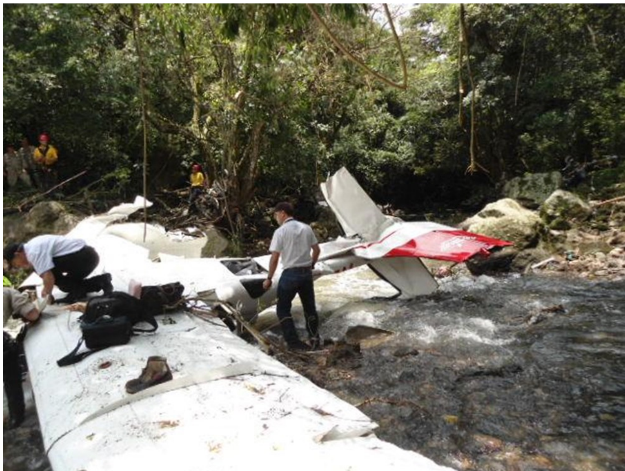
Imagen 16: Marcas y deformaciones observadas en el empenaje 3.
