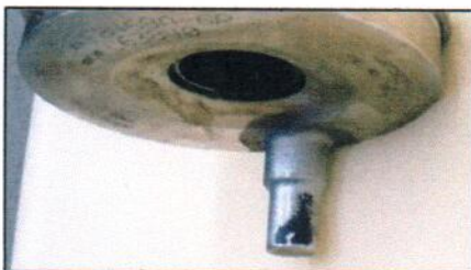
Imagen 3. PROPELLER BLADE N° 1, Radius Bushing, Pitch Change
