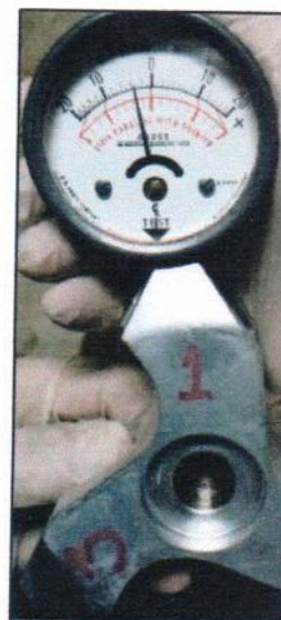
Imagen 6. Magnetismo remanente después de inspección, punta N°1.
