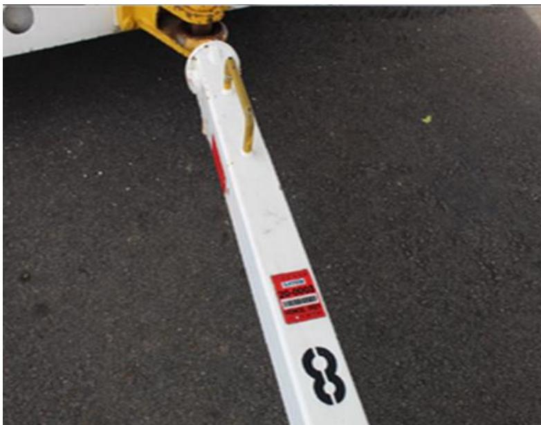
**Imagen 34.** Barra de remolque PSE-192. Designación de control numérico.
