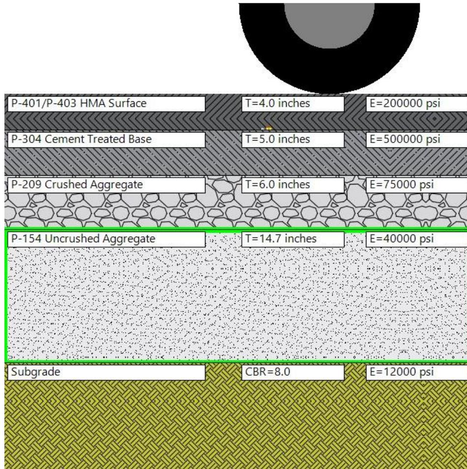
Figura B-10. Gráfico de PCR para el ejemplo flexible 2
